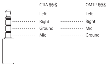
図 4 極ステレオミニプラグの信号割り当て
