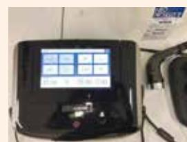
伊藤超短波UST770。タッチパネルで操作がしやすい。画面の右側が温熱モード、左側がLIPUSモード。それぞれ独立して操作することができます。
